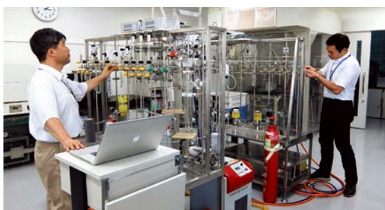
年代実験室の真空ライン装置（歴博）
