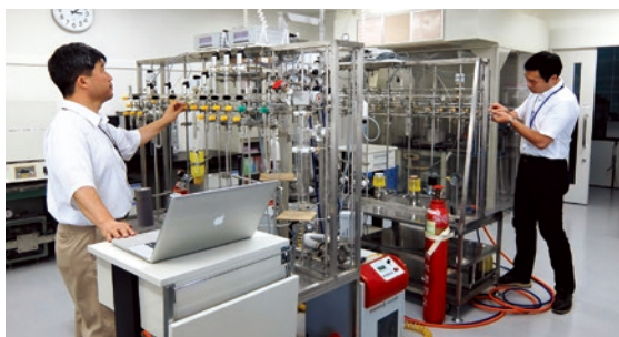
年代実験室の真空ライン装置（歴博）
