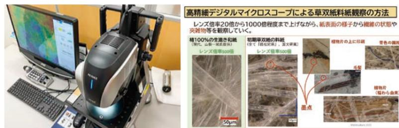
▲マテリアル分析研究に使用する高精密デジタル顕微鏡と、研究成果の一例（左：高精密デジタル顕微鏡、右：松原哲子（古典籍データ駆動研究センター）日本近世学会（2022年6月12日）発表資料）
